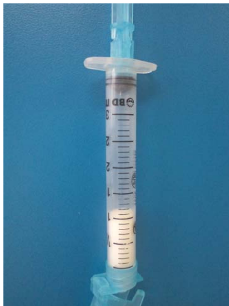
Figura 7 – Coluna cromatográfica recheada com sílica gel
