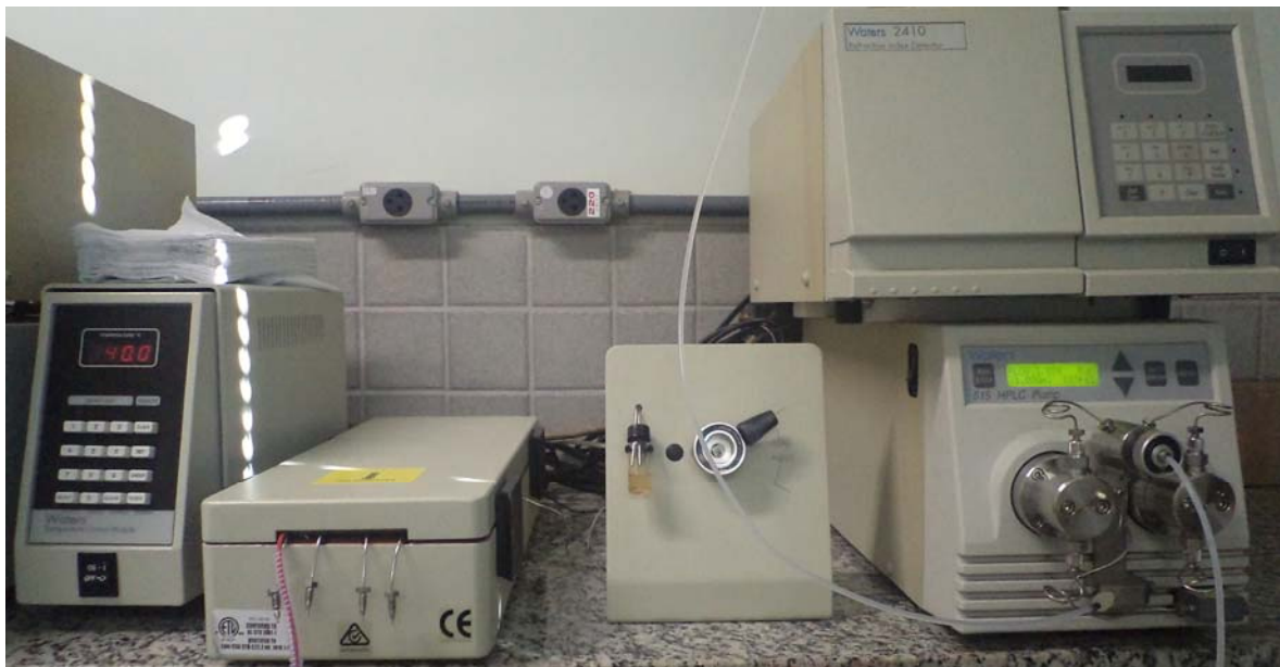
Figura 10 – Foto do equipamento de GPC utilizado para determinação de aditivos detergentes/dispersantes em gasolina
