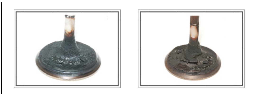
Figura 3 – Fotos de válvulas de motor com o uso da gasolina sem aditivos. Fonte: www.br.com.br . Acesso 03 de setembro de 2011.
